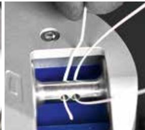
Das Ende des Fadens durch die Schlaufe führen.
