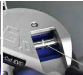
Den Faden in Verbindung mit dem Akkuschrauber und Bithalter in Pfeilrichtung aufwickeln.
