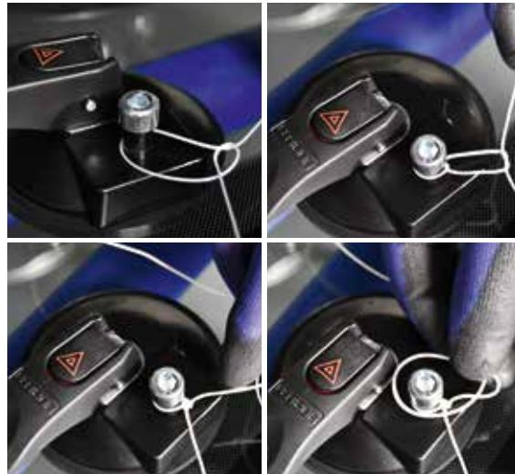
Coloque el Single-Cut EVO 5.0 y la ventosa – soporte en la cara interna del parabrisas.
